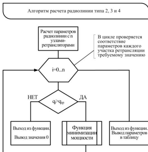
Рис. 3. Алгоритм поиска оптимального маршрута прохождения радиосигналов в автоматизированной сети ДКМ радиосвязи с адаптивным управлением структурно-параметрическим ресурсом
